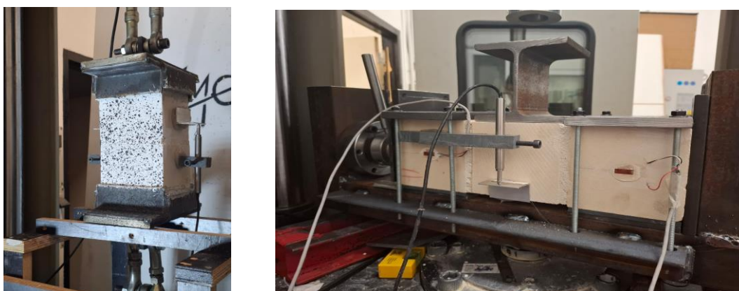
Figure 1 : Essai de traction sur doublets (gauche) et de cisaillement sur triplets (droite)
